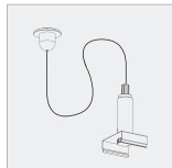
Cavo di sospensione. Lunghezza cavo max 2m.
